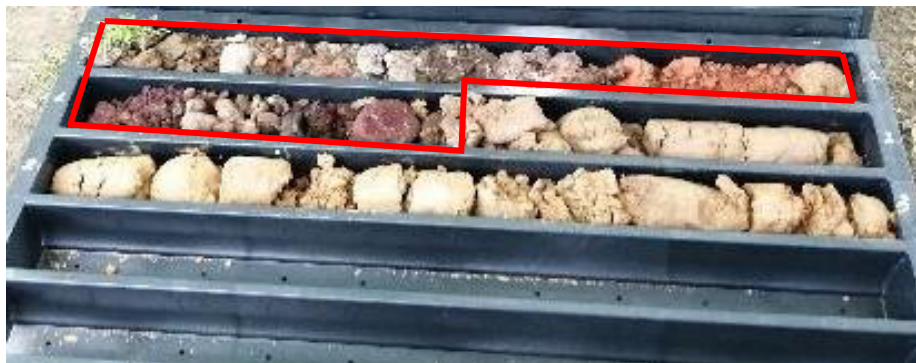
Figura 3 - cassetta catalogatrice con livello di materiale di riporto
