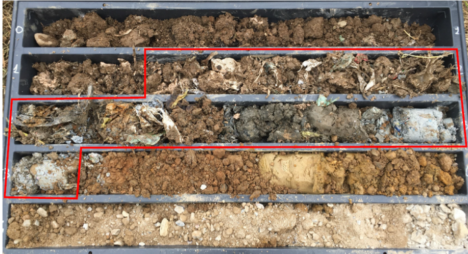
Figura 4 – cassetta catalogatrice con materiali di riporto e rifiuti interrati
